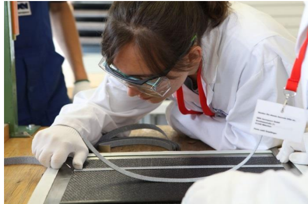
Schneiden von Kohlefasermatten im Camp bei der GKN Aerospace Deutschland GmbH und an der Hochschule der Bayerischen Wirtschaft (HDBW) in München. Hier tüftelten die Mädchen an der Einsetzbarkeit von ultraleichten und ultrastabilen Werkstoffen in der Luftfahrt. Fotos: bbw e. V.
